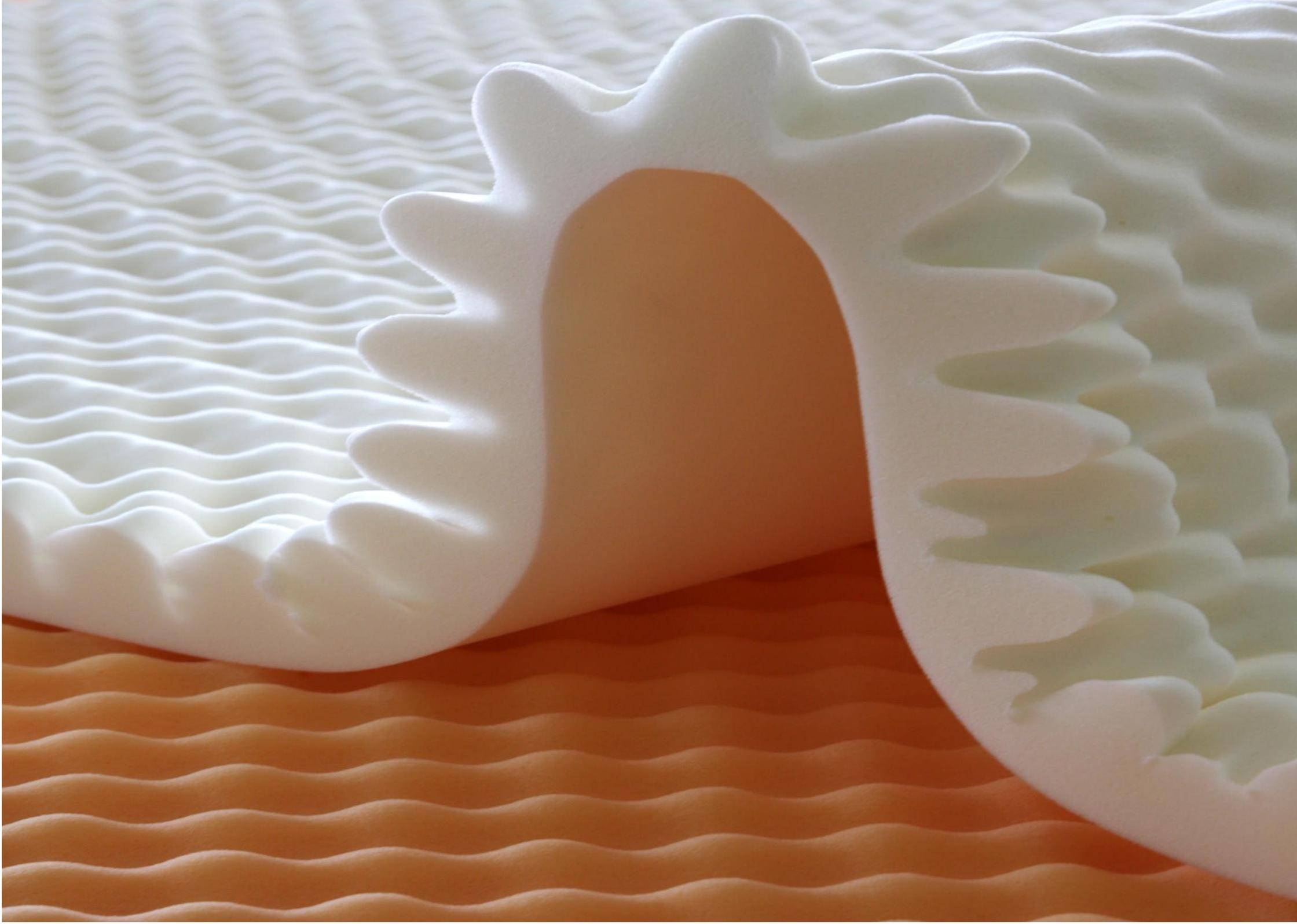
Può essere agevolmente accoppiato, mediante incollaggio o a secco, con altre tipologie di poliuretano o con diversi materiali quali gel, tessuti tecnici e polimeri in genere, creando sandwich multi materiali che rappresentano una soluzione altamente performante nel mondo delle imbottiture.
