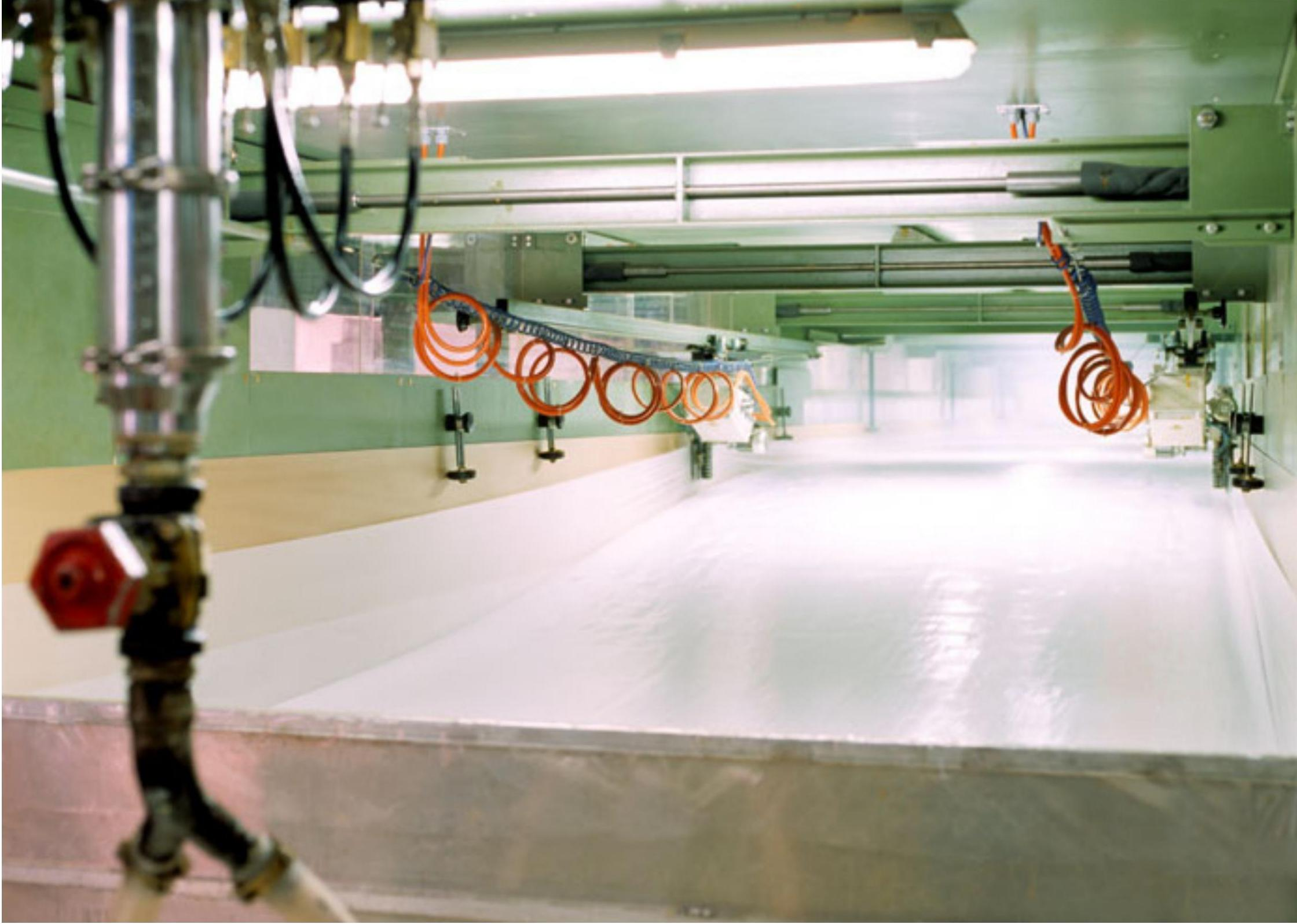
Il poliuretano Thermofresh ® viene prodotto in lunghi blocchi di circa 25 metri di lunghezza. Una volta completato il processo di polimerizzazione, i blocchi vengono sezionati e destinati alla fase di stagionatura che permette al materiale di raggiungere il suo massimo livello prestazionale.
